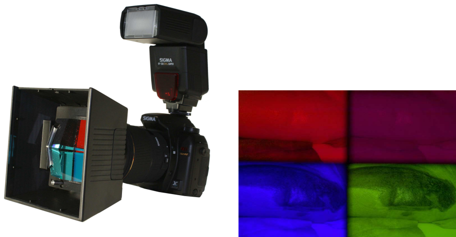
Abb. 1. links: Darstellung von Kamera und Objektiv; rechts: Originäres Bild der Kamera mit einzelnen Rot-, Infrarot-, Blau- und Grünkanälen.
