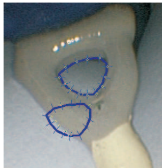
Abb. 1. Darstellung zweier ins Endoskopbild projizierter Objektkonturen mit auf Konturnormalen gefundenen Bildkanten (mit Kreisen markiert). Die jeweiligen Korrekturmatriizen werden basierend auf der Anzahl der gefundenen Kantenpunkte entlang der Normalen sowie deren Abstand zur Kontur bewertet.
