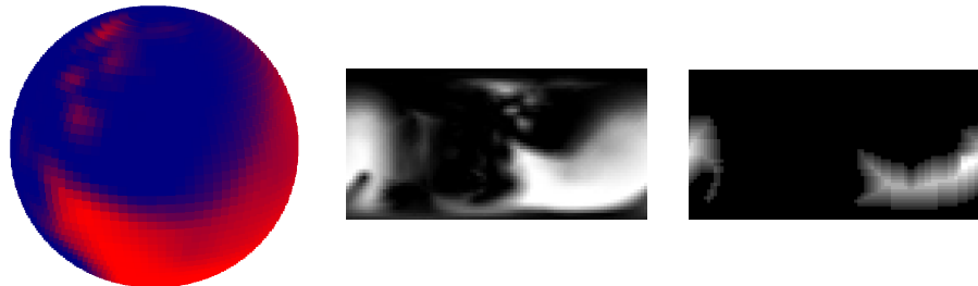
Abb. 3. Visibility Map: Die Kugel wird mittels Mercator-Entwurf auf eine ebene Fläche projiziert (links), Zwischenergebnis der Bewertungsfunktion an einer Kameraposition (Mitte), Ergebnis nach Anwendung einer Distanzfunktion auf das binarisierte Zwischenergebnis (rechts)
