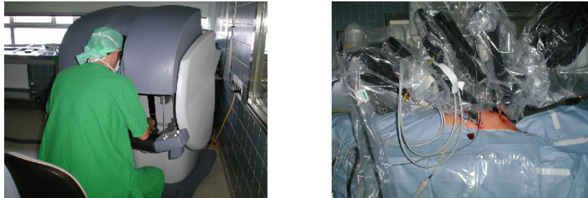
Abb. 1. Ein Telemanipulator-System für die minimal-invasive Chirurgie ( da Vinci , Intuitive Surgical): Der Chirurg steuert von einer Konsole aus (links) die Arme des Systems, an denen die Instrumente und ein Endoskop angebracht sind (rechts).
