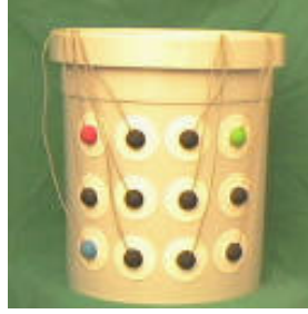
Abb. 2. Phantom mit zwölf Oberflächenelektroden. Das Phantom wird mit dem Kamera- und dem Röntgensystem aufgenommen. Im Inneren des Phantoms befindet sich während der Röntgenaufnahme ein Meßkatheter.
