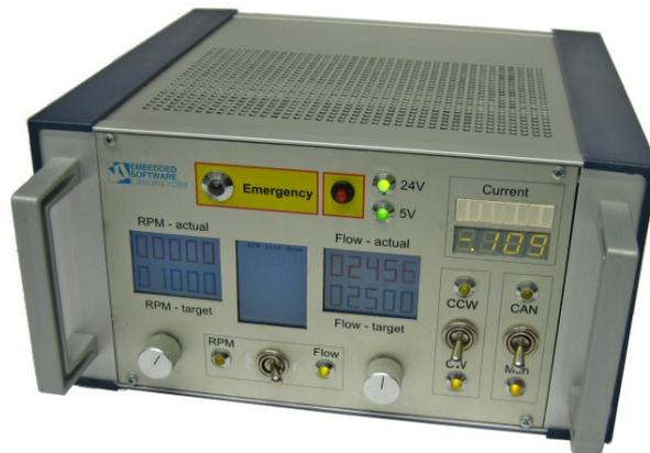
Abbildung 3.8: Entwickelte Konsole zur Regelung der eingesetzten Diagonalpumpen (Abbildung entnommen aus [Gathmann(2011)])
